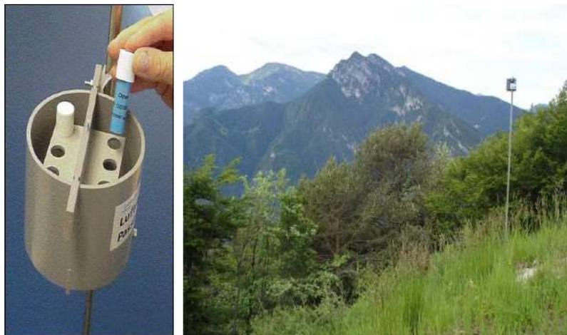
Figura 2. A sinistra: campionatore passivo con fiale e supporto (da <http://www.passam.ch/>); a destra: modalità di esposizione in una stazione forestale.
